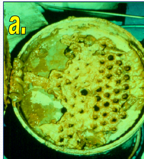
(a) Bündelwärmetauscher, (b) Kalk und Biofilm mit unterschiedlichen Mikroorganismen.
