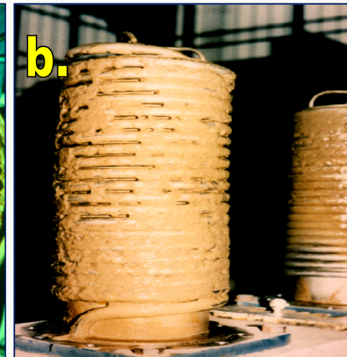
(a) Bündelwärmetauscher, (b) Kalk und Biofilm mit unterschiedlichen Mikroorganismen.
